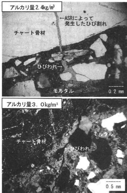
図16 チャートYoを用いたコンクリート供試体の偏光顕微鏡写真
