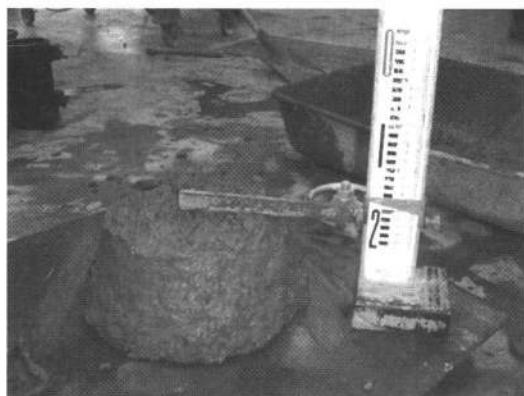
図7 試験①のスランプ試験状況
