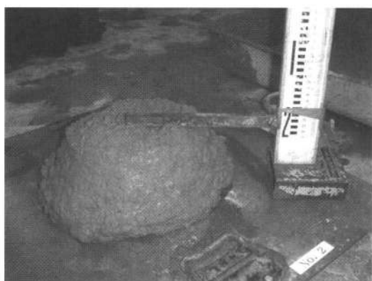
図8 試験②のスランプ試験状況
