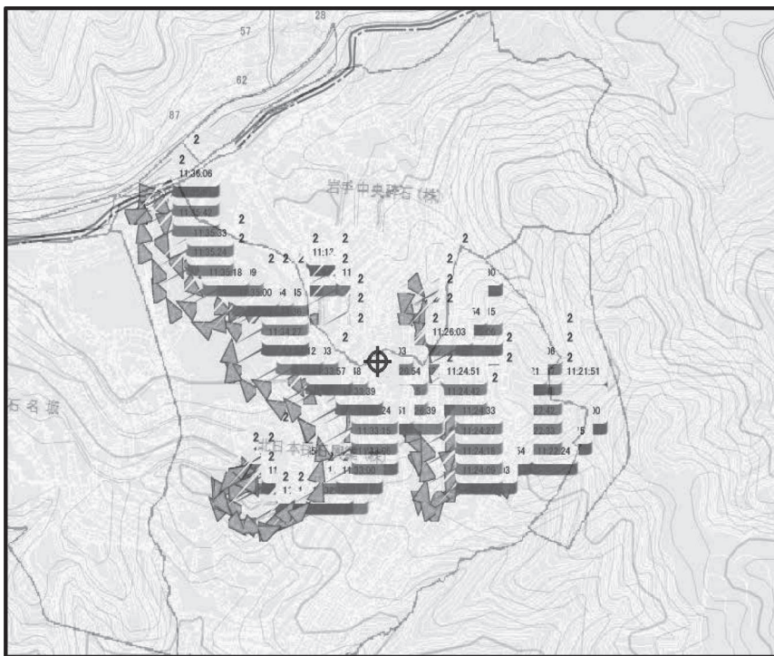
図5 デジタル無線機を介して転送した原石ダンプトラックの走行軌跡
