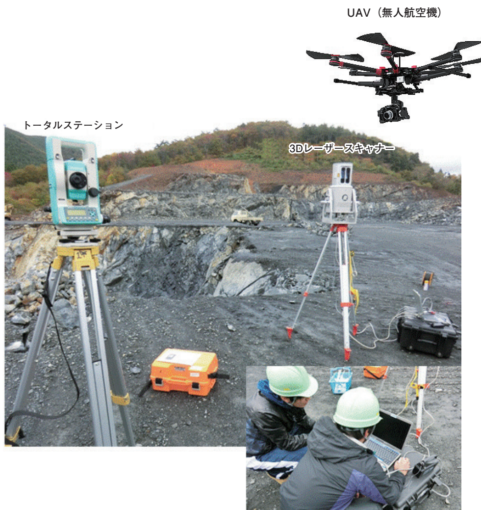
図14.6.3 地形情報リアルタイム測量システムの例
